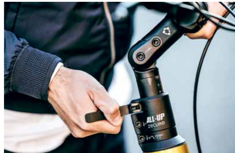
Praktisches Detail: Der Lenker lässt sich mit wenigen Handgriffen und ohne Werkzeug in der Höhe verstellen.
